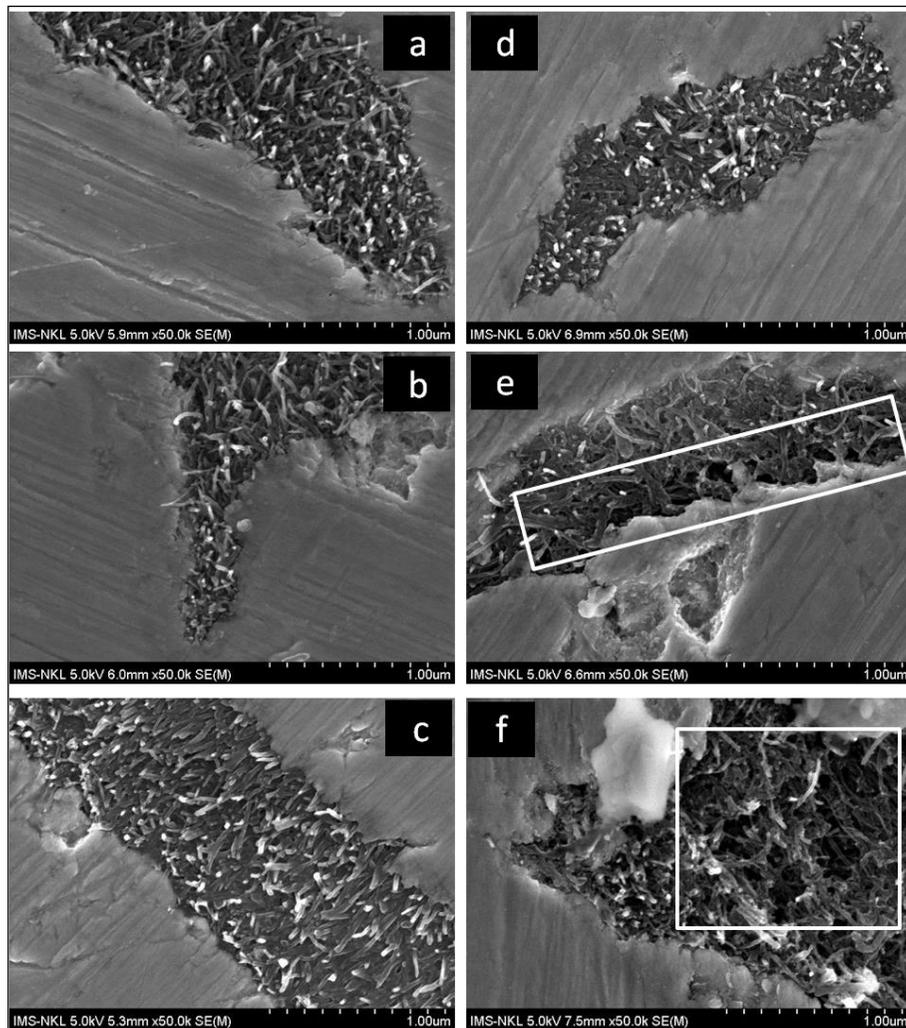
**Fig. 4** FESEM images of sintered samples focused on CNTs clusters: a) UT.Cu-0.5CNT, b) UT.Cu-1.0CNT, c) UT.Cu-1.5CNT, d) NU.Cu-0.5CNT, e) NU.Cu-0.5 and f) NU.Cu-1.5CNT
